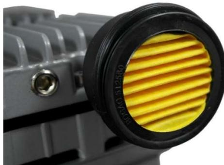
*Foto Nr. 6: Luftschalldämpfer im Schalldämpfer montiert.*
