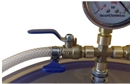
Foto Nr. 8: Pneumatischer Schlauch am Kugelhahnstutzen, gesichert mit einer Schneckenklemme.
