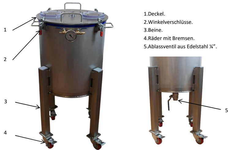
Foto Nr. 12: Vakuunkammer mit dem Rührwerk.
