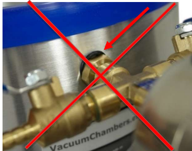
Foto Nr. 5: Ventilsinsel mit falscher Lage des O-Rings.
