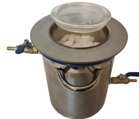
Foto Nr. 18: Vakuum-Kühlfalle mit Trockeneis gefüllt.
