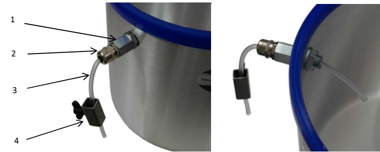
Foto Nr. 10: Vakuumdurchlass mit Durchflussregler und Schlauch am Behälter montiert.
