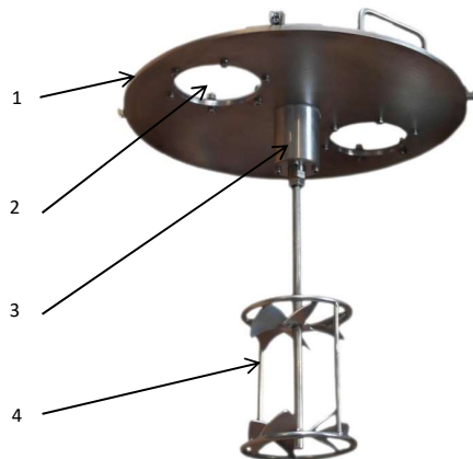
Foto Nr. 13: Rührwerk am Deckel montiert.
