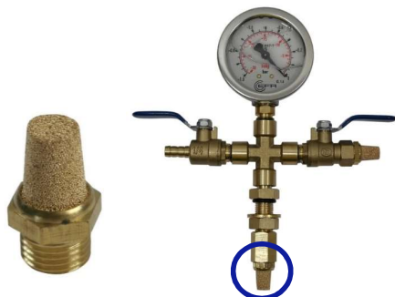
Foto Nr. 9: Schalldämpfer und Ventilinsel mit einem montierten Schalldämpfer.
