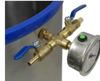
Foto Nr. 6: Ventilsinsel korrekt montiert.
