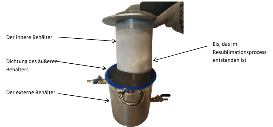
Foto Nr. 17: Interner und externer Behälter und das erfrorenen Material, das auf dem inneren Behälter gesammelt wurde.
