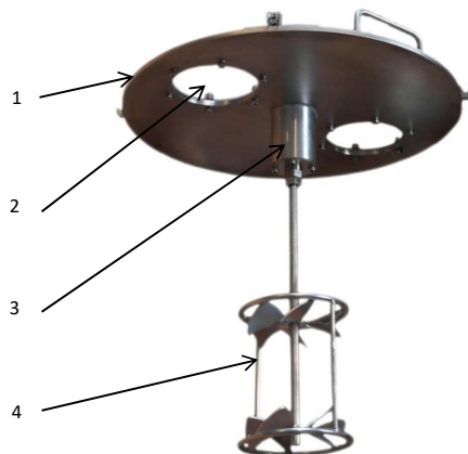
Foto Nr. 13: Rührwerk am Deckel montiert.
