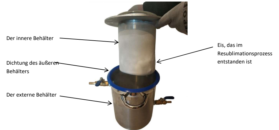
Foto Nr. 17: Interner und externer Behälter und das erfroren Material, das auf dem inneren Behälter gesammelt wurde.
