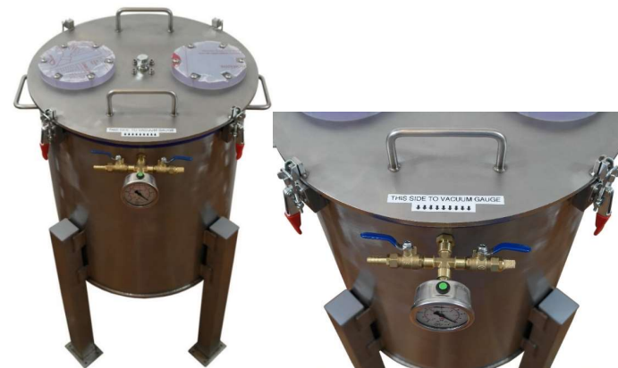
Foto Nr. 14: Richtige Position des Deckels auf der Vakuumkammer.
