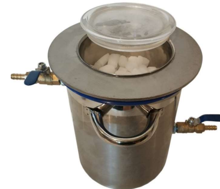
Foto Nr. 18: Vakuum-Kühlfalle mit Trockeneis gefüllt.
