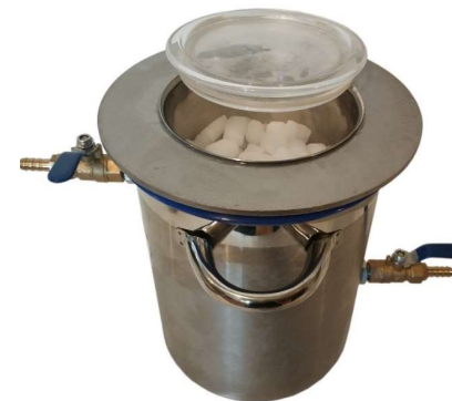
Photo n° 18: Refroidisseur sous vide rempli de neige carbonique.
