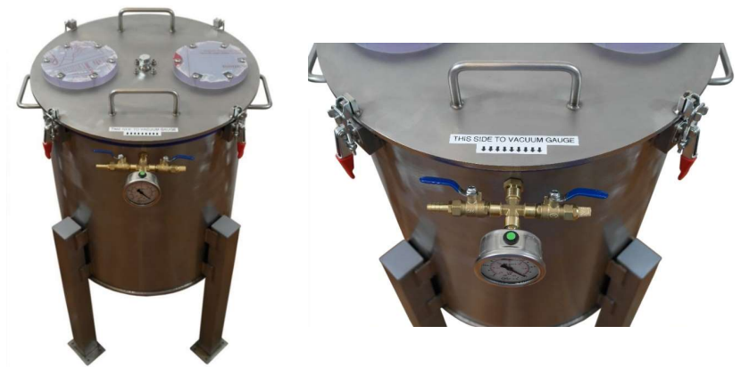
Photo n° 14: Placement correct du couvercle sur la chambre.
