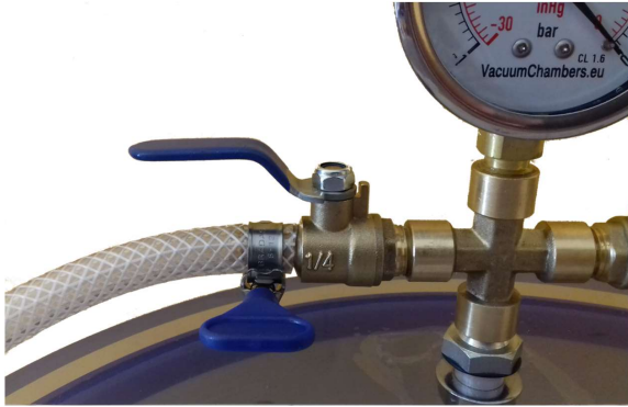
Photo n° 8: Tuyau pneumatique monté sur le connecteur du robinet à tournant sphérique, sécurisé par un collier à vis sans fin.
