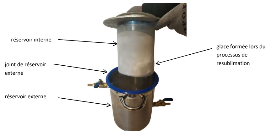
Photo n° 17: Réservoir interne et externe et matériel congelé recueilli dans le réservoir interne.
