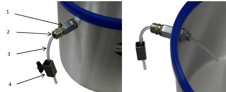
Photo n° 10: Traversée de vide avec régulateur de débit et tuyau monté sur le réservoir.
