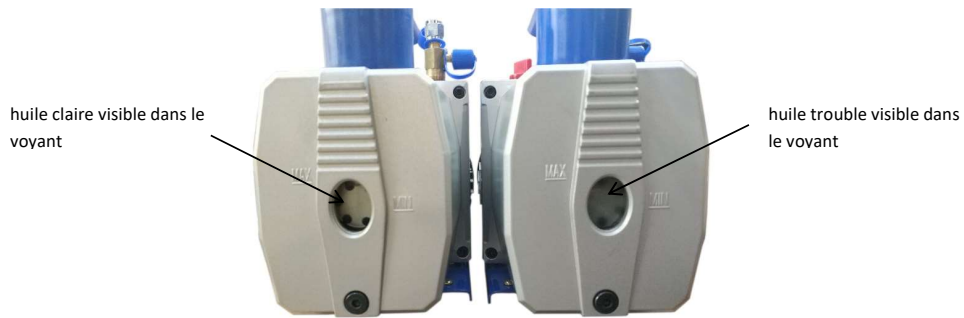
Photo n° 19: Efficacité du refroidisseur sous vide - propreté de l'huile dans les pompes à vide (à gauche : huile claire lorsque le refroidisseur est utilisé, à droite : huile trouble lorsqu'aucun refroidisseur n'est utilisé).
