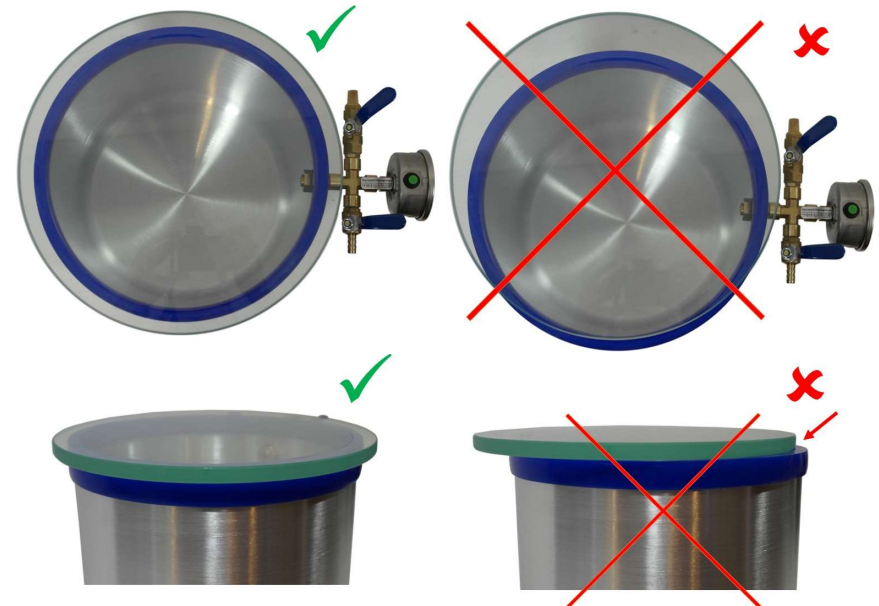
Photo n° 20: Placement correct (à gauche) et incorrect (à droite) du couvercle sur la chambre.
