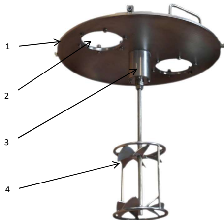
Photo n° 12: Agitateur monté sur le couvercle.
