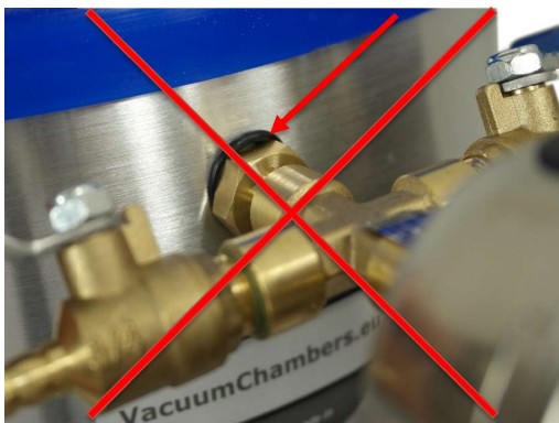
Foto n. 5: Isola valvole con o-ring montata in modo errato.
