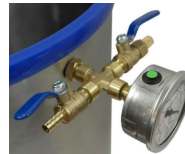
Foto n. 6: Isola valvole correttamente installata.
