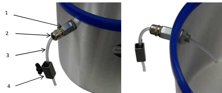
Foto n. 10: Canale sotterraneo del vuoto con regolatore di flusso e tubo montato sul serbatoio.
