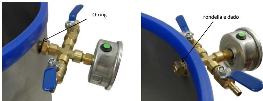
Foto n. 4: Isola valvole correttamente inserita nel foro.
