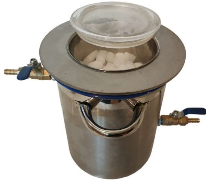
Foto n. 18: Raffreddatore sottovuoto riempito con ghiaccio secco.
