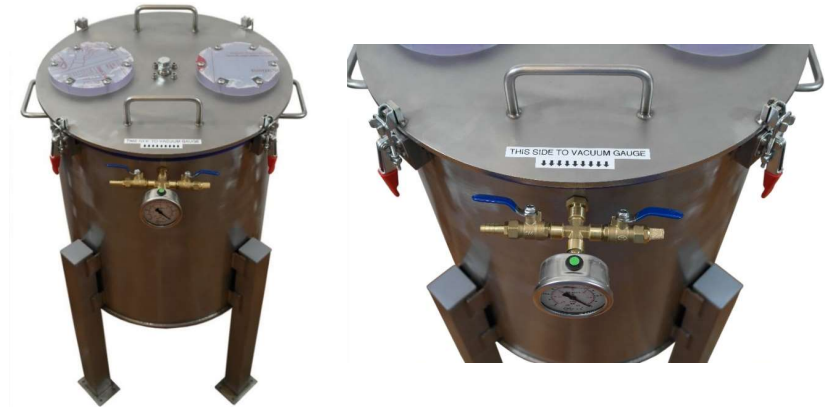
Foto n. 14: Posizionamento corretto del coperchio sulla camera.
