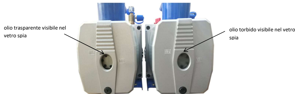
Foto n. 19: Efficienza del raffreddatore sottovuoto - pulizia dell'olio nelle pompe a vuoto (a sinistra: olio limpido quando si usa il raffreddatore, a destra: olio torbido quando non si usa il raffreddatore).
