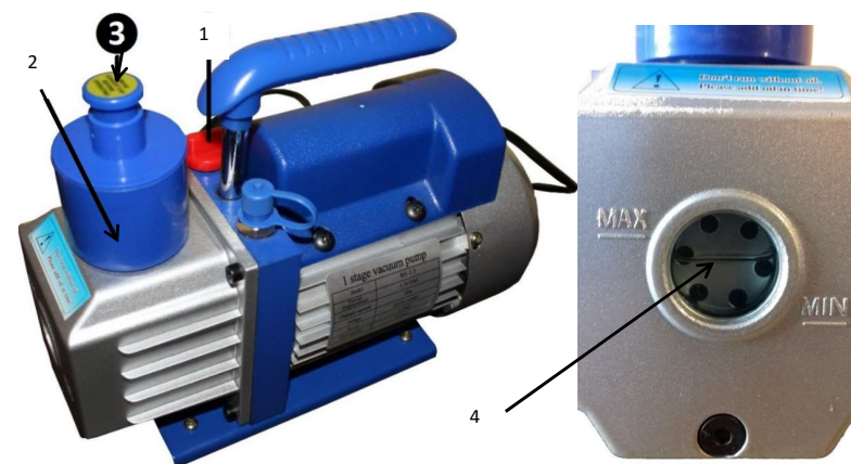
Foto n. 7: Pompa per vuoto e corretto livello dell'olio.
