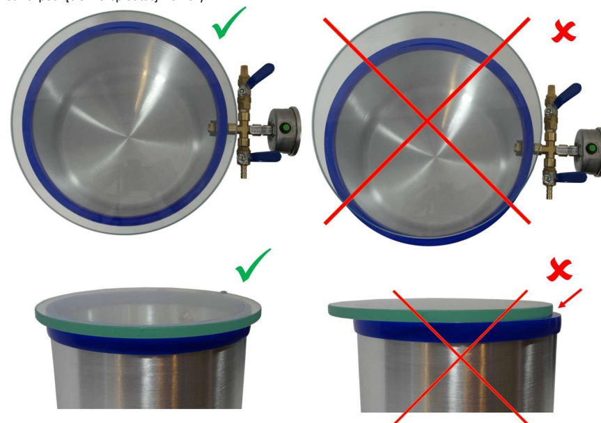
Zdjęcie nr 20: Prawidłowe (po lewej) i nieprawidłowe (po prawej) ułożenie wieka na komorze.
