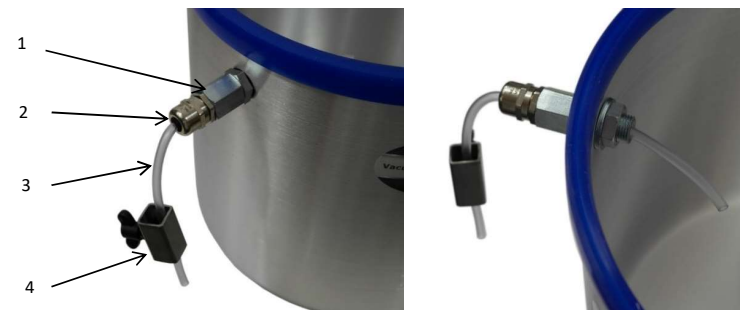
Zdjęcie nr 10: Przepust próżniowy z regulatorem przepływu i węże zamontowane na zbiorniku.
