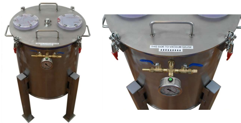
Zdjęcie nr 14: Prawidłowe umiejscowienie wieka na komorze.
