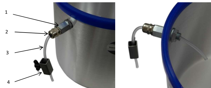
Zdjęcie nr 10: Przepust próżniowy z regulatorem przepływu i węże zamontowanym na zbiorniku.
