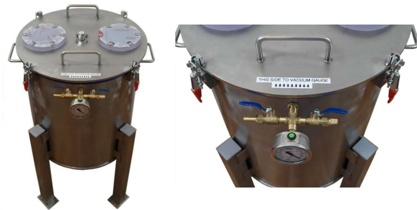
Zdjęcie nr 14: Prawidłowe umiejscowienie wieka na komorze.
