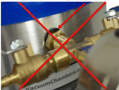
Zdjęcie nr 5: Wyspa zaworowa z błędnie zamocowanym o-ringiem.
