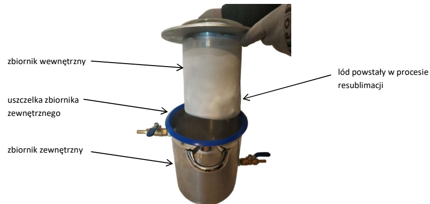
Zdjęcie nr 17: Zbiornik wewnętrzny i zewnętrzny oraz wymrażany materiał zgromadzony na zbiorniku wewnętrznym.
