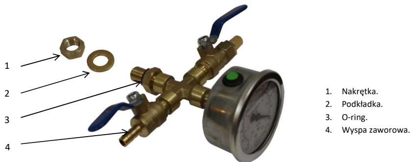
Zdjęcie nr 3: Wyspa zaworowa oraz elementy służące do jej montażu.
