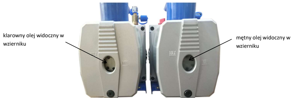
Zdjęcie nr 19: Skuteczność wymrażacza próżniowego – czystość oleju w pompach próżniowych (po lewej: klarowny olej w przypadku stosowania wymrażacza, po prawej: mętny olej w przypadku braku wymrażacza).
