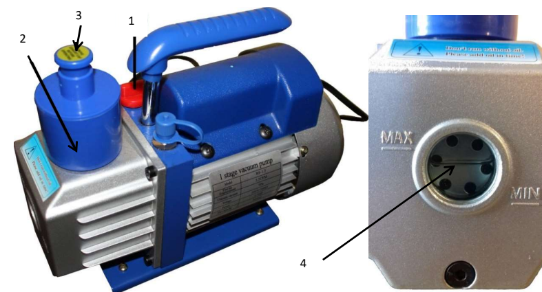
Zdjęcie nr 7: Pompa próżniowa oraz prawidłowy poziom oleju.
