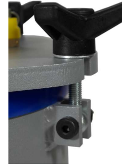
Zdjęcie nr 5: Prawidłowo zamocowane zapięcie komory ciśnieniowej.
