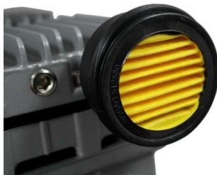
Zdjęcie nr 5: Filtr tłumika powietrza zamontowany w tłumiku.
