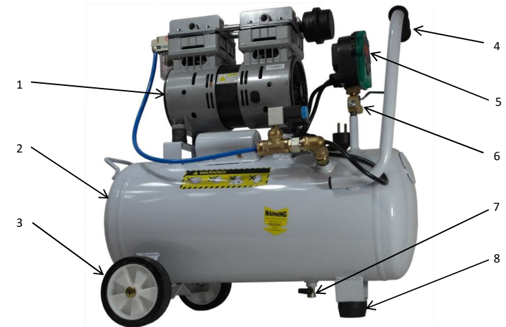
Zdjęcie nr 2: Pompa tłokowa ze zbiornikiem wyrównawczym i cyfrowym regulatorem ciśnienia.
