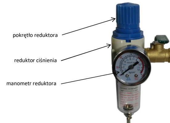
Zdjęcie nr 2: Filtr powietrza wylotowego z reduktorem ciśnienia i manometrem.
