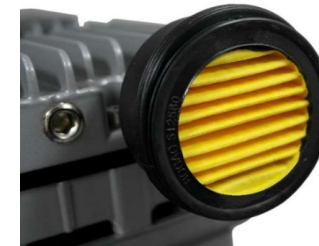
Zdjęcie nr 4: Filtr tłumika wlotu powietrza zamontowany w tłumiku.
